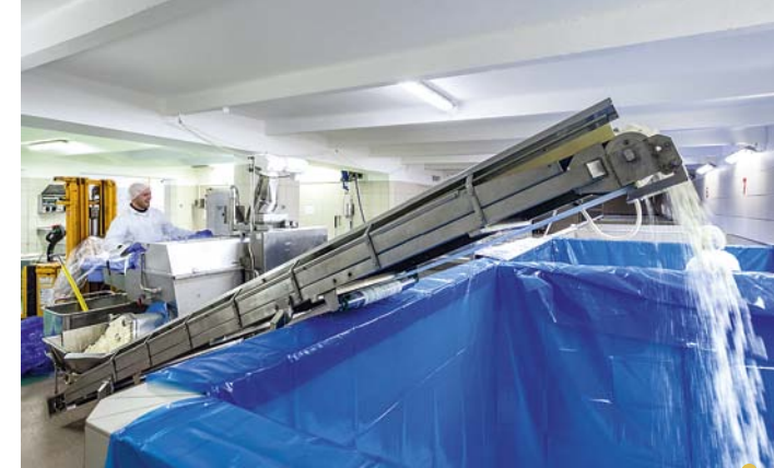
Namletý a nasolený tvaroh míří z dopravníku do nádrže.
